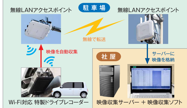
(左) ドライブレコーダーの映像データをWi-Fi接続を利用して収集 (右) 無線バックホール接続を利用して転送し、社内サーバーへ
